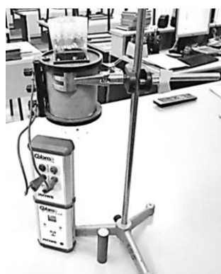
Рис. 2. Демонстрационный эксперимент «ЭДС индукции, возникающий при падении магнита через катушки». Зарегистрировано датчиком напряжения цифровой лаборатории Cobra4
