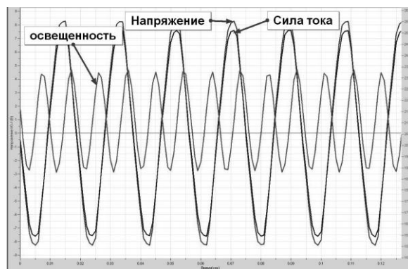
Рис. 3. Демонстрационный эксперимент «Активная нагрузка в цепи переменного тока». Зарегистрировано датчиками силы тока, напряжения и освещенности цифровой лаборатории «Архимед»
